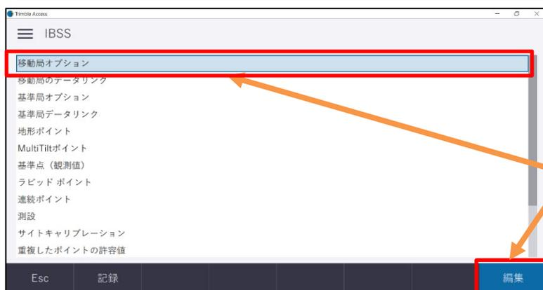
メインメニュー／設定／測量スタイルをタップし、GNSS 観測で利用する測量スタイルを選択します。
