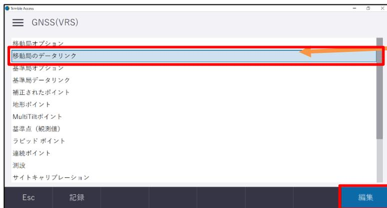
**移動局のデータリンク**を選択し、**編集**ボタンをタップします。
