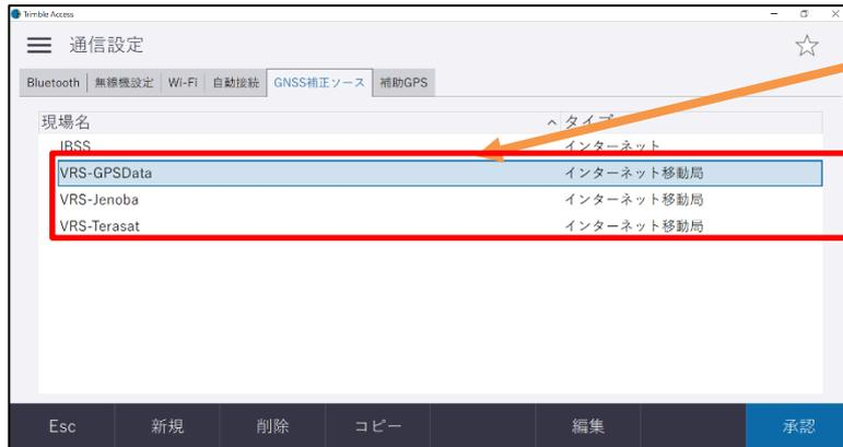
GNSS(VRS)観測スタイルを選択すると、通信設定／GNSS 補正ソース画面を表示します。お客様が契約している補正信号配信会社を選択してください。
